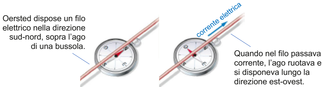
FIGURA 17 L'esperimento di Oersted.
